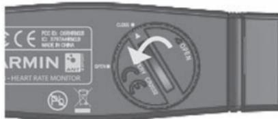
2. С помощью монеты поверните крышку против часовой стрелки, чтобы стрелка на крышке показывала на надпись OPEN (открыть).
