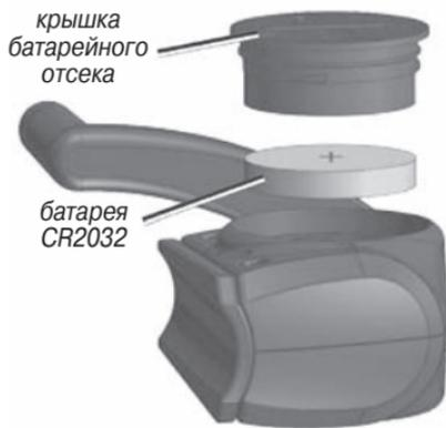
2. С помощью монеты поворачивайте крышку против часовой стрелки, пока она полностью не отвинтится.
