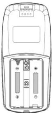
1. Поверните винт крышки батарейного отсека против часовой стрелки до тех пор, пока не станет возможным отделить крышку от прибора.
