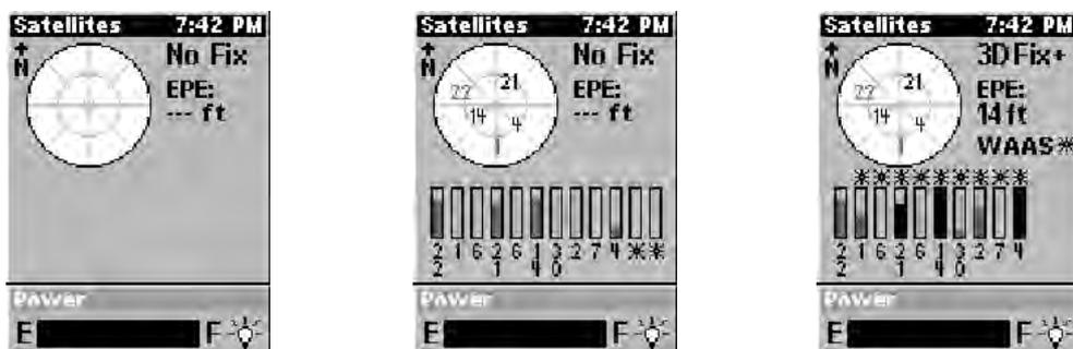
**Страница «Информация о спутниках».** Рисунок слева показывает, что опознанные спутники отсутствуют, и текущие координаты не определены; на центральном рисунке изображен процесс сканирования и на правом – конечная картина после фиксации необходимого количества спутников, определения действующей в данной местности системы позиционирования (GPS или WAAS) и трехмерных координат.
