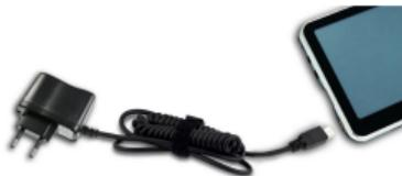
**[Внимание]** В процессе зарядки аккумулятора индикаторная лампа горит красным цветом. При полной зарядке аккумулятора цвет индикатора станет зеленым. Пожалуйста, не отсоединяйте зарядное устройство до тех пор, пока аккумулятор не зарядится полностью, и заряжайте его только по необходимости. Для увеличения службы аккумуляторной батареи рекомендуется ее максимально разряжать и затем максимально заряжать.
