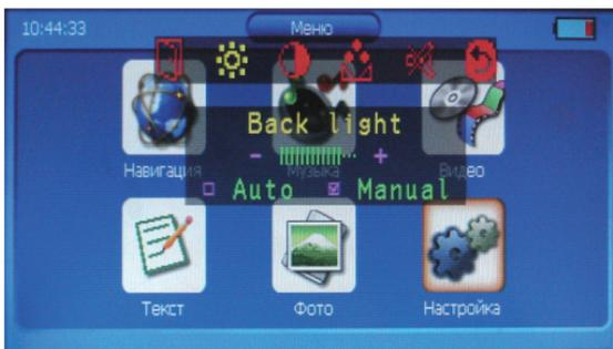
Для настройки нажмите стилусом на соответствующие иконки. Для регулировки уровня нажмите + или - стилусом на экране. Если не нажимать по экрану в течении 10 секунд, прибор автоматически выходит из дополнительного меню.
